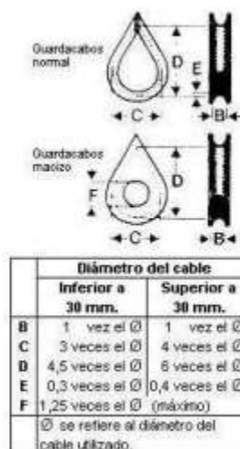
Fig. 4: Criterio orientativo para la elección del guardacabos
