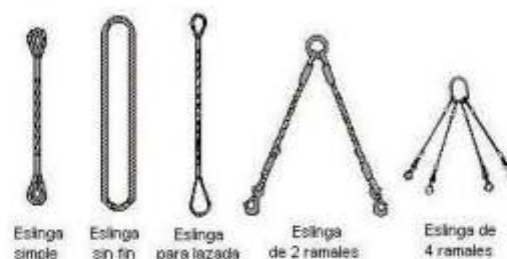
Fig. 6: Tipos de eslingas
