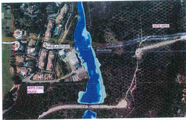
Figura 2: DPH probable (línea azul oscuro), Zona Servidumbre (línea verde), Zona de Policía (línea rosa), Inundación fluvial con periodo de retorno de 10 años (en color azul oscuro), Inundación fluvial con periodo de retorno de 100 años (en color claro) e Inundación fluvial con periodo de retorno de 500 años (en color turquesa)
